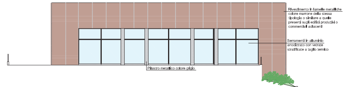
PROSPETTO OVEST scala 1:300
